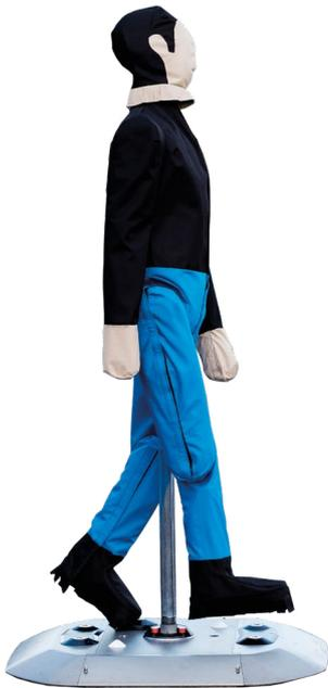
DRIのSoft Pedestrian 360は、次世代の多関節を有する歩行者型ソフトターゲットであり、車両保護性能を進化させ、まったく新しいレベルのリアリズムをVRUテストにもたらしめます。
