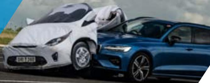
GST 120は、車両の先進運転支援システム(ADAS)の試験で使用できる、現在最高性能を誇るプラットフォームです。最高速度120km/hのGST 120は、高速道路における現実的な速度で高速道路走行アシストやパイロットシステムを駆動できる市場で唯一の製品です。
