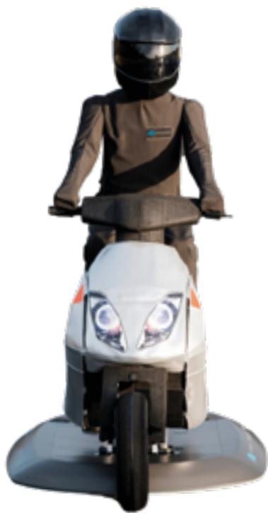
360软两轮车是一款高度逼真、经济的替代两轮车目标，它的稳定速度可达60 km/h。逼真的外形、车轮旋转速率与车速相匹配、质感真实的乙烯基皮肤，这些都增加了车辆传感器系统（包括摄像头、雷达和激光雷达）对它的识别和检测。
