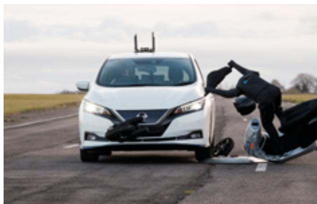
为应对全球对两轮车和电动两轮车日益增长的需求，360软两轮车应运而生。该目标符合ISO/WD19206-5标准，并与C-NCAP 2021协议兼容。其适用的测试场景包括：
