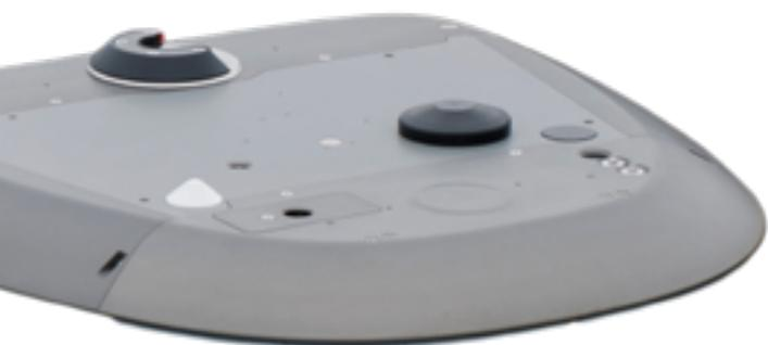
LaunchPad Spin是一款ADAS目标平台，它将VRU测试的可操作性水平提升到新的高度。其就地转弯、单轮转向的能力，使其能够在瞬间旋转360度，因此您的测试可以高度复现现实世界中行人常见的快速变化方向的行为。此外，它的最高速度为30公里/小时，也使其能够测试自行车骑手和电动两轮车骑手相关的场景。
