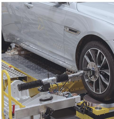
作为业界领先的车辆动力学和合规性 (K&C) 测试机, SPMM 能够收集对车辆行驶和操控性能至关重要的准静态悬挂特性。
