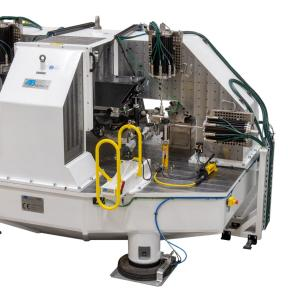
ANVH 250 是一款精密的轴级测试机,它能精确测量通过悬挂系统传入车 体的噪声、振动和粗糙度 (NVH)。
