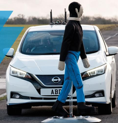
作为新一代的铰接式替代行人目标、DRI 的 Soft Pedestrian 360™ 让 VRU 测试达到了全新的真实性水平。
