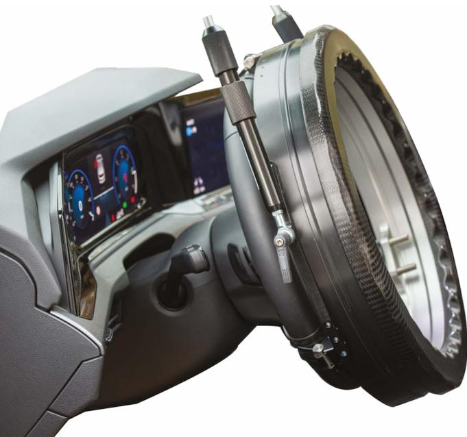
Halo 机器人是一种直接驱动的中空转向机器人，能够以高精度和高重复性施加各种转向输入，因此可以获得高质量的数据。
