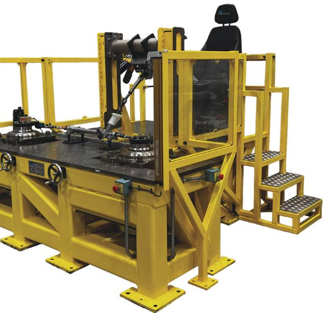
SSTM 是一种先进的转向系统测试机器,能够完成液压、EPAS 和线控转向系统的特性分析、机械硬件在环 (mHiL) 以及驾驶员在环 (DiL) 活动。
